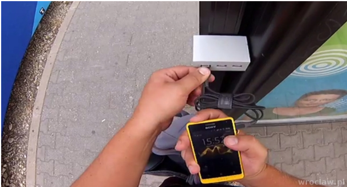
przystanek z możliwością ładowania urządzeń przez USB Sosnowiec, Koszalin, Wrocław, Opole, Lublin, Rzeszów, Łódź
